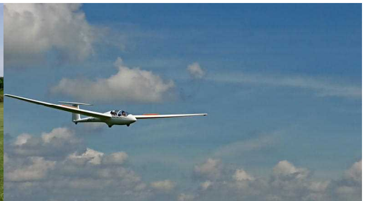
着陸の様子です。 主翼から、ダイブブレーキという板を出し、 抵抗を増やすことで、降下してきます。
