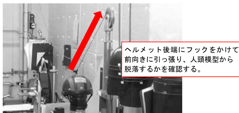
写真3. 保持装置の性能試験の様子
