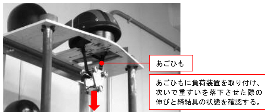
写真 2. 保持装置の強さ試験の様子
