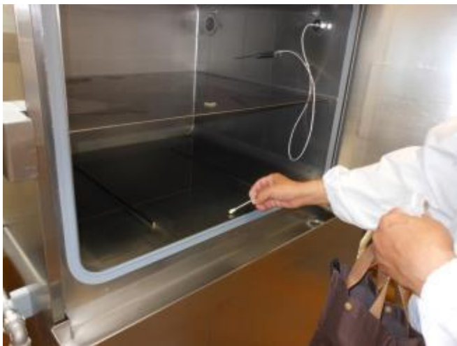
使用後の真空冷却機の衛生状態を検査(残留菌)
