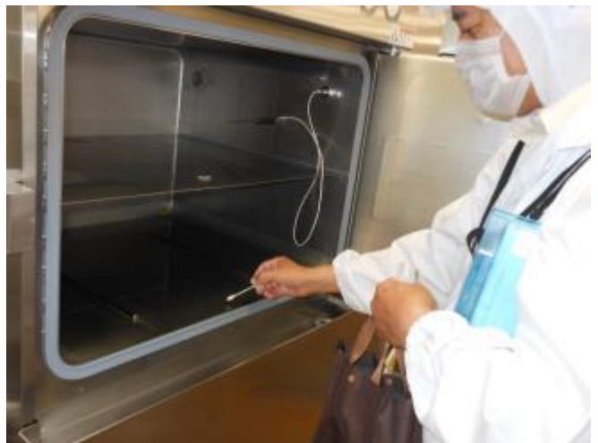
使用後の真空冷却機の衛生状態を検査(残留菌)
