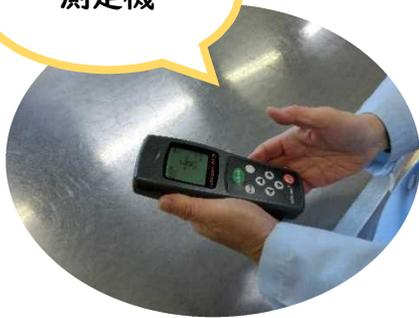
綿棒で検査対象のものをふき取ります。(下の写真) 綿棒ホルダーを本体に戻して、本体の中の発光試薬を十分に振って溶かします。(右の写真) 測定機の中に入れて、ボタンを押して、10秒たつと測定されます。いろいろなものを測定して、確認をしました。
